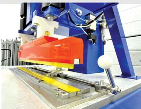
Специальный механический прижим гарпуна (в отличие от ручной заправки материала) обеспечивает его раскрытие и надежную фиксацию в процессе сварки, увеличивая качество сварки и производительность работ более, чем два в раза.
