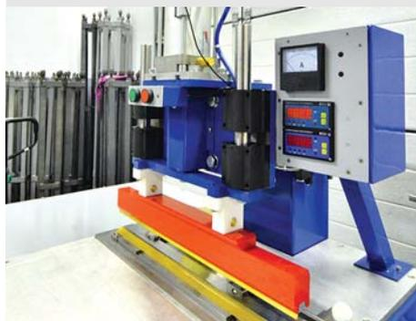
Реле времени позволяет устанавливать требуемое время сварки и время дожига, и производить сварку в программируемом режиме. Регулировка силы тока и давления пресса позволяют быстро настроить станок в зависимости от толщины используемой ПВХ пленки и типа используемого гарпуна.
