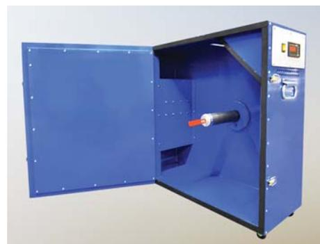
Полупроводниковый нагревательный элемент повышенной надежности и температурный датчик позволяют устанавливать и поддерживать требуемый тепловой режим, что значительно снижает энергоемкость производства за счет минимизации тепловых потерь при подогреве гарпуна.
